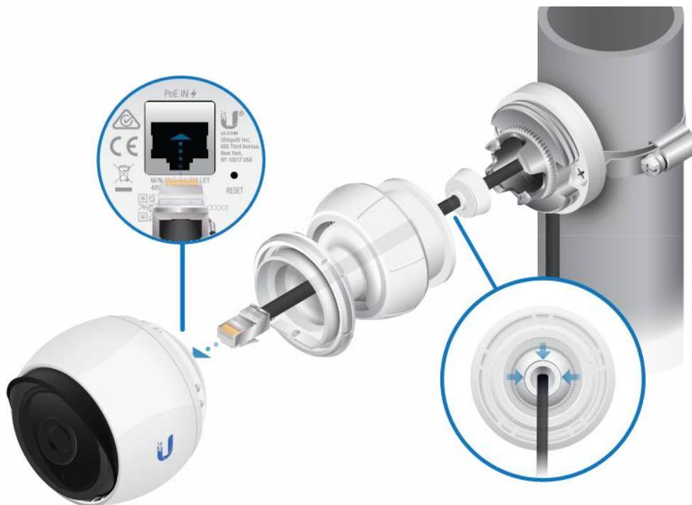
**!** **IMPORTANTE:** Asegúrese de que el casquillo de cable esté bien asentado durante la instalación y el trazado de los cables.
