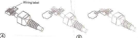
Place wiring cap on plug.
