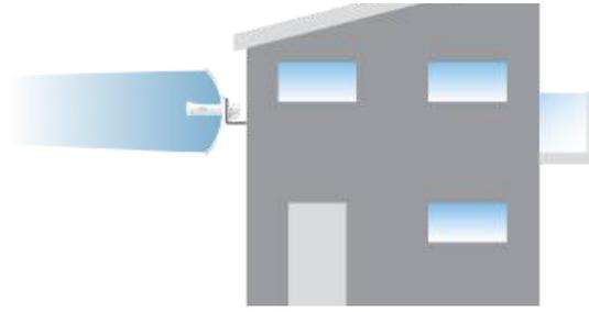
El PowerBeam montado en el exterior sin el reflector instalado proporciona cobertura solamente del exterior al interior a través del bocina de alimentación de 3 dBi.
