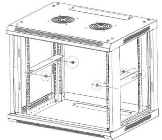
4. Alinee la perforación ovalada del soporte en L (lado más corto) con los orificios de montaje cuadrados en el riel, y proceda a fijarlo utilizando los tornillos M6x12 y tuercas con retén M6 que se incluyen con la unidad.
