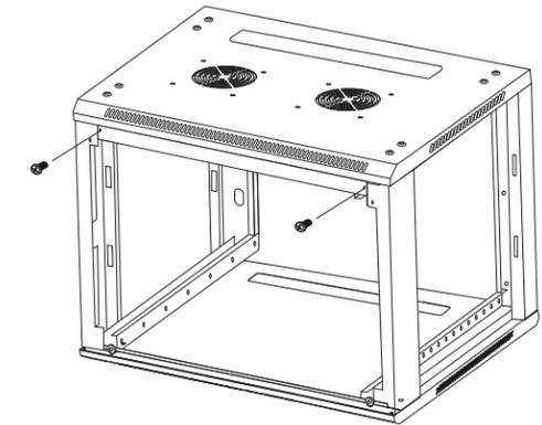
4. Fije la placa de acceso para cables a la bandeja de ventilación con los tornillos autorroscantes M4x8mm.
