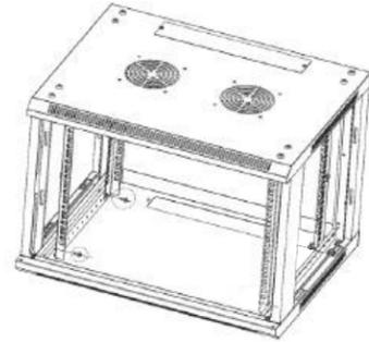
**Nota:** los orificios de montaje deben coincidir exactamente con los de arriba y los de la base, con el fin de evitar el desalineamiento.
