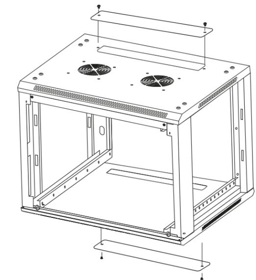
**Nota:** una vez armado el marco, proceda a apretar los tornillos hasta el final con el fin de asegurar, alinear y cuadrar debidamente la estructura.
