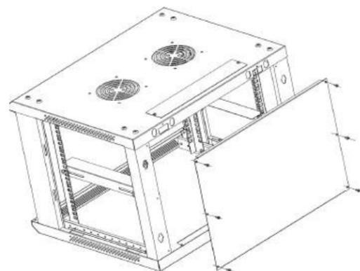
**Nota:** recuerde de apretar completamente los tornillos una vez que todos ellos hayan sido instalados.
