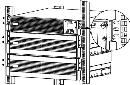
**NOTA:** Dado el gran peso, el uso de soportes de montaje en bastidor es obligatorio durante la instalación en bastidor (guá con soporte en forma de L). Por la misma razón, se recomienda que el SAI y la batería se instalen en la parte inferior del armario del bastidor. En caso de ser necesario, el accesorio de kit opcional de rieles puede adquirirse por separado.
