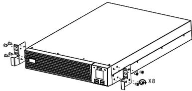
❷ Levante el módulo del SAI y deslícelo para introducirlo en la carcasa del bastidor. Fije el módulo del SAI al bastidor con tornillos, tuercas y arandelas (no suministrados el paquete) a través de sus soportes de montaje en los rieles.
