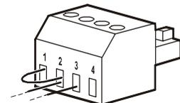
Utilice uno de los siguientes tipos de cables para conectar el SAI al interruptor de EPO.
