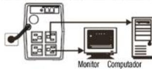
Atención: NO conecte una impresora láser ni escáner en ninguno de los enchufes de la UPS. La corriente que absorben estos dispositivos puede recargar la unidad y posiblemente, dejarla fuera de servicio.
