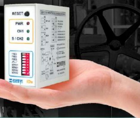
Detecta la presencia de vehículos midiendo su masa metálica a través de la Medición de la inductancia de una espira detectora
