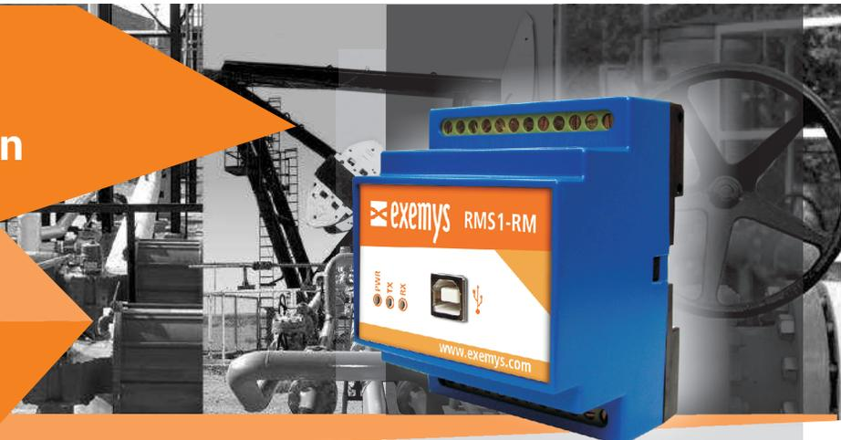
El RMS1-RM permite expandir la cantidad de entradas y salidas digitales y analógicas de cualquier sistema de control o automatización manejado desde el protocolo Modbus Serie (RTU o ASCII). Puede funcionar como un contador de pulsos en sus entradas digitales. También permite crear un "túnel" de entradas/salidas digitales o analógicas, usando el modo maestro.
